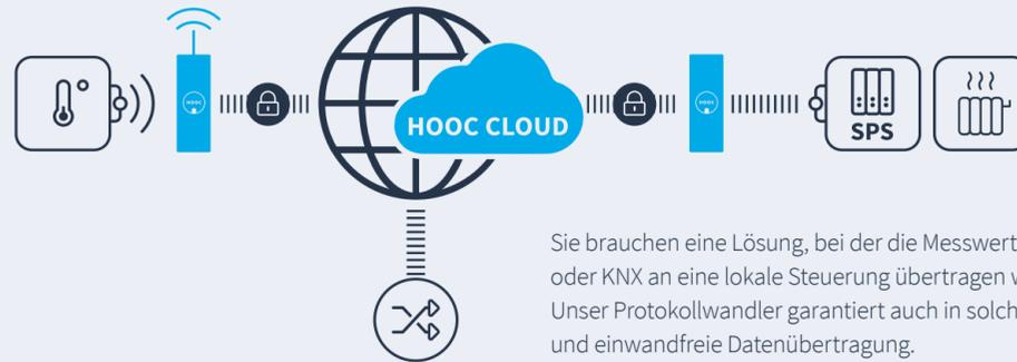
Sie brauchen eine Lösung, bei der die Messwerte mittels Modbus TCP oder KNX an eine lokale Steuerung übertragen werden? Kein Problem! Unser Protokollwandler garantiert auch in solchen Fällen eine sichere und einwandfreie Datenübertragung.
