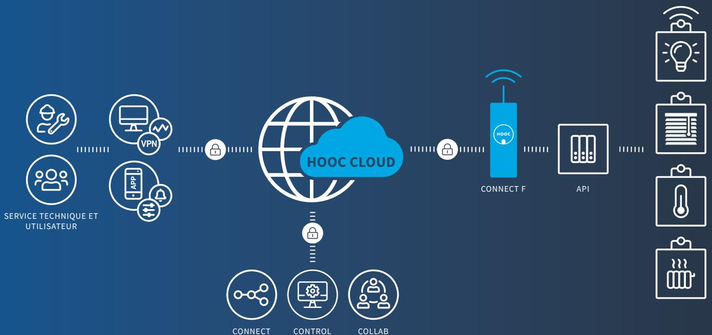
**La solution** (de gauche à droite) : L'utilisateur (responsable technique, opérateur, etc.) se connecte via sa Client-App ou le ManagementPortal pour accéder au HOOC Cloud via une connexion sécurisée. De là, il peut accéder, grâce à la passerelle HOOC, à ses différents systèmes informatiques, installations CVC ou applications de maison intelligente.
